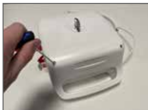
2. Ta bort batteriluckan med insexnyckeln.
