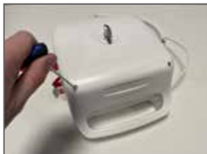
2. Entfernen Sie die Batterieabdeckung mit dem Inbusschlüssel.
