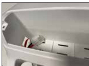
7.2. Ta bort den övre kåpan (notera kablarna och kontakterna)
