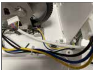
3. Schuif de kabelhouder en zet hem vast.
