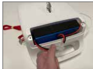
3. Koppla bort batteriet.
