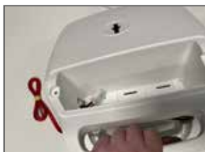
7.1. Ta bort den övre kåpan (notera kablarna och kontakterna)
