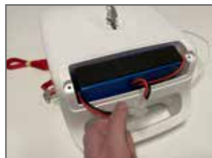
3. Koppla bort batteriet.
